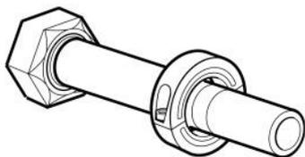
✓ Die beiden Halbschalen werden auf dem Isolierband zum Ring geschlossen und zusammengeschraubt.
