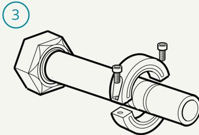
Die beiden Ringhälften wieder vollständig schließen. Der Merus Ring darf etwas größer als die Leitung sein. Er muss aber unbedingt ganz geschlossen werden.
