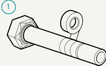
Die Wasserleitung mit **Isolierband** umwickeln, wo der Merus Ring installiert werden soll.
